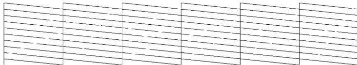
Wenn Sie fehlende Linien im Testmuster feststellen, müssen Sie die Druckköpfe reinigen. Drücken Sie die Taste **Cleaning** auf dem Bedienfeld länger als 3 Sekunden oder greifen Sie in der Druckersoftware auf die EPSON Drucker-Utilities und dort auf **Utility Druckkopfreinigung** zu. Siehe "Druckerhilfsprogramme verwenden" für Windows oder "Druckerhilfsprogramme verwenden" für Macintosh.
