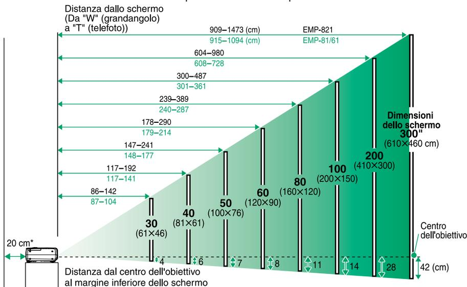
\*Con l'installazione a muro, lasciare uno spazio di circa 20 cm tra il proiettore e il muro.
