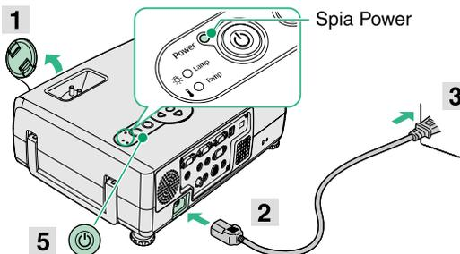
Viene emesso un segnale acustico per indicare l'accensione del proiettore. La spia Power lampeggia in verde e la proiezione ha inizio (riscaldamento in corso). L'impostazione dell'opzione Protetto da password può fare sì che venga visualizzata la schermata di immissione della password ogni volta che il proiettore viene acceso. In questo caso, immettere la password.
