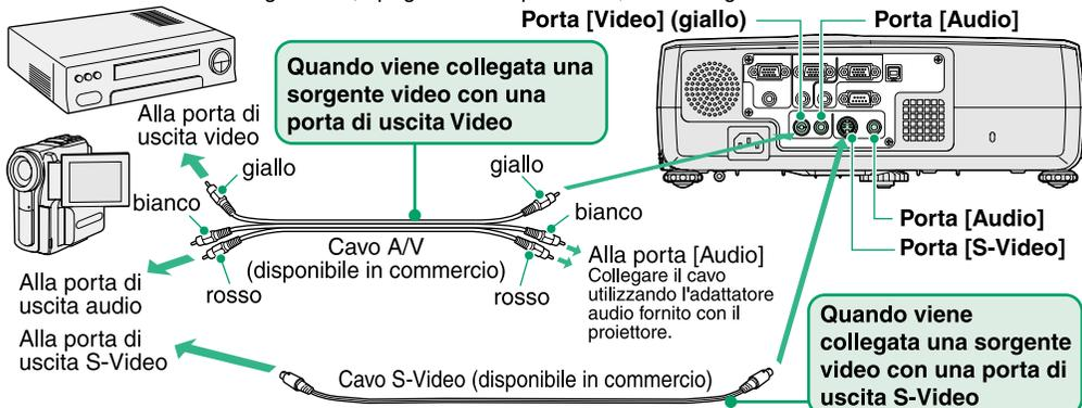
\*Per riprodurre l'audio tramite l'altoparlante incorporato del proiettore, utilizzare l'adattatore audio (fornito con il proiettore) per collegare un cavo A/V (disponibile in commercio) alla porta di ingresso [Audio] corrispondente alla sorgente video collegata.
