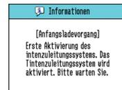
**Vorsicht:** Schalten Sie den Drucker während der Befüllung des Tintenzuleitungssystems nicht aus.
