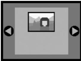
Drücken Sie die Taste **Start** zur Auswahl des Vorlagentyps. Die Vorlage wird gescannt und eine Vorschau des Fotos im LCD-Bildschirm angezeigt.
