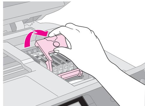
4. Saque el cartucho que vaya a sustituir. Mueva la lengüeta de la parte posterior del cartucho y tire de él hacia arriba. Deséchelo con cuidado. No desmonte ni intente rellenar el cartucho usado.
