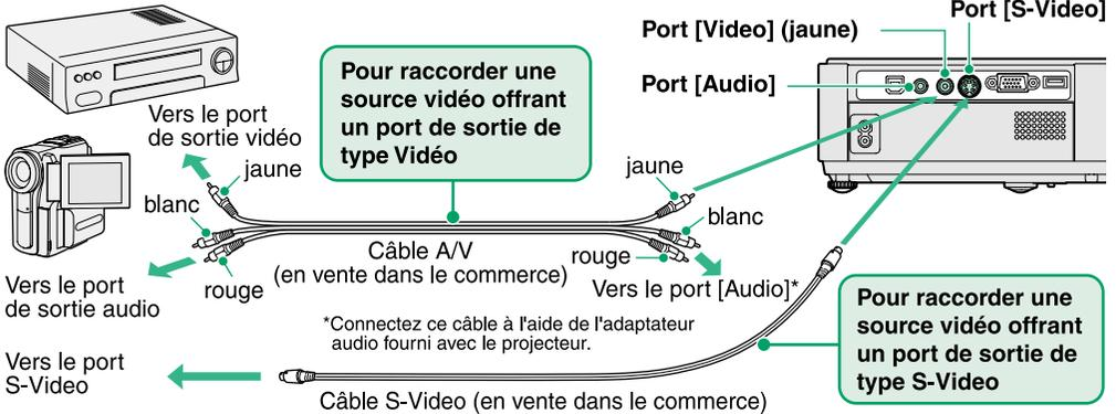
Si vous souhaitez utiliser le haut-parleur intégré au projecteur pour reproduire le son, utilisez l'adaptateur audio (fourni avec le projecteur) pour connecter un câble A/V (en vente dans le commerce) au port d'entrée [Audio] correspondant à la source vidéo raccordée au projecteur.
