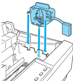
3. Inserire la spina dell'unità del motore nel connettore sulla stampante.
