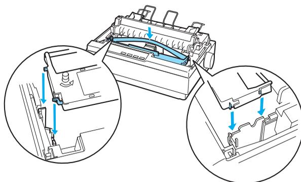
7. Utilizzare un oggetto appuntito, ad esempio una penna a sfera, per inserire il nastro tra la testina di stampa e la guida del nastro.
