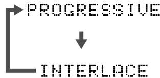
Alle Abtastzeilen werden in einem Videofeld angezeigt. Dadurch wird eine deutlich bessere Bildqualität als beim Zeilensprungverfahren (Interlacing) erreicht.
