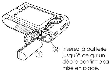
3. Fermez le couvercle du logement de la batterie et faites-le glisser vers la gauche jusqu'à ce qu'un déclic confirme sa mise en place.
