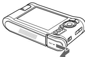
2. Insérez la batterie dans le compartiment en suivant le sens de la flèche figurant sur l'autocollant apposé sur la batterie.
