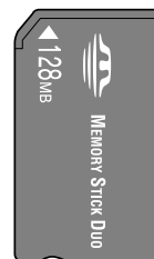
بطاقة *Memory Stick Duo بطاقة *Memory Stick PRO Duo بطاقة *MagicGate Memory Stick Duo (* تحتاج إلى مهابئ)
