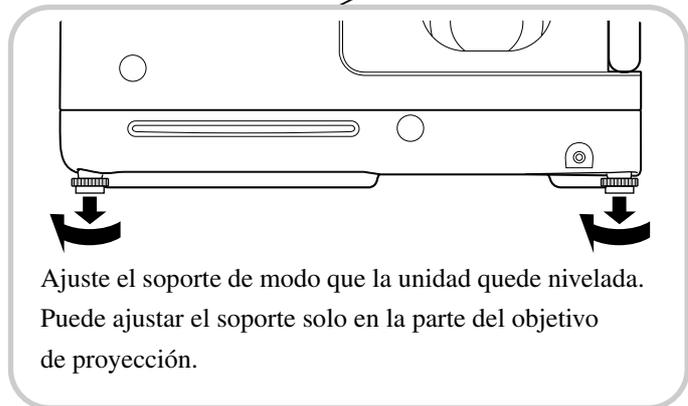
Ajuste el soporte de modo que la unidad quede nivelada. Puede ajustar el soporte solo en la parte del objetivo de proyección.
