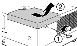
**3** Afloje los tornillos de fijación de la lámpara.
