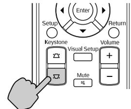
Si la unidad se inclina 15° en sentido ascendente o descendente, puede corregir la forma de la imagen. Sin embargo, el enfoque será difícil si el ángulo de inclinación es considerable.
