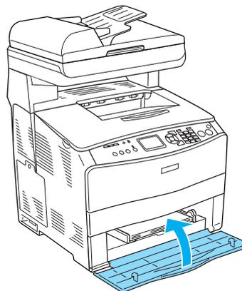
4. Öffnen und schließen Sie die Abdeckung A.
