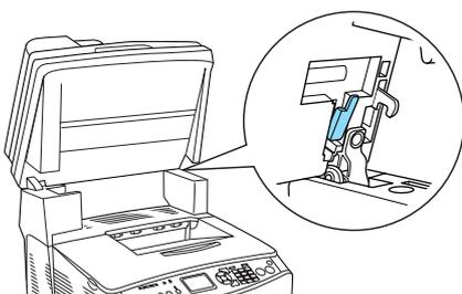
2. Öffnen Sie die Abdeckung C und ziehen Sie dann die beiden grünen Hebel an der Fixiereinheit nach oben, um sie zu entriegeln.
