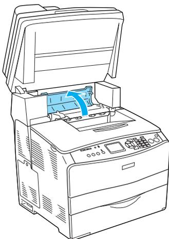
3. Ziehen Sie die beiden grünen Hebel der Fixiereinheit nach oben, um sie zu entriegeln.
