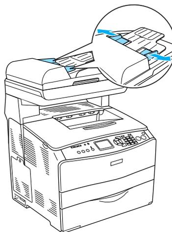
2. Schieben Sie den Vorlagenstapel mit der Vorderseite nach oben in den automatischen Vorlageneinzug, bis er auf Widerstand stößt, und schieben Sie die Führungen dann an die Vorlagen.
