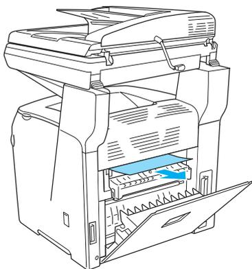
6. Drücken Sie die beiden grünen Hebel an der Fixiereinheit nach unten und schließen Sie dann die Abdeckung C.
