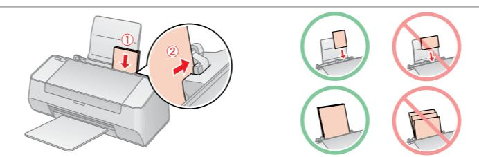
Încărcați hârtia cu partea imprimabilă orientată în sus.
