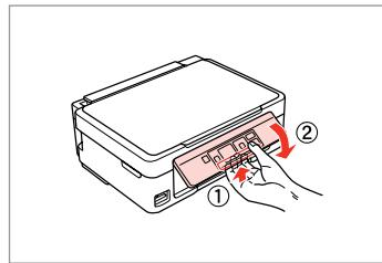
Če želite spustiti ali zapreti ploščo, jo odklenite, tako da povlečete ročico zadaj, da se zaskoči, nato pa jo spustite. Plošče nato preprosto dvignite.
