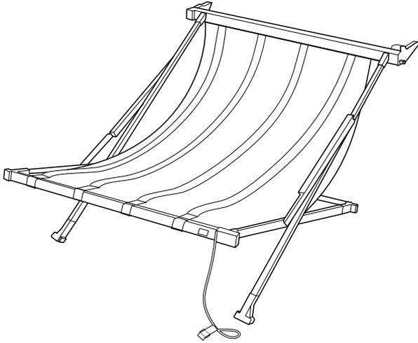
Специальная корзина для специальных пленок Epson. Вы можете отсоединять ее от принтера и хранить отдельно, если она не используется.
