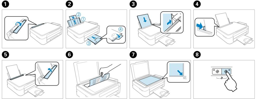
**1** Zabezpiecz głowicę drukującą. Zajistěte tiskovou hlavu. Rögzítse a nyomtatófejet.
