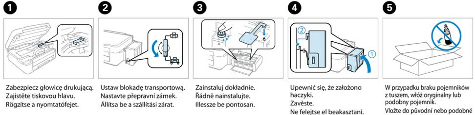
**1** Zabezpiecz głowicę drukującą. Zajistěte tiskovou hlavu. Rögzítse a nyomtatófejet.
