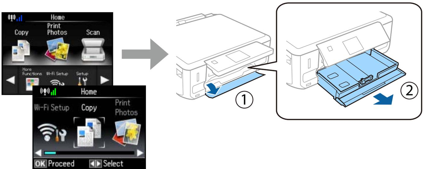
Der Drucker verfügt über eine untere und eine obere Kassette. Achten Sie darauf, die untere Kassette herauszuziehen.
