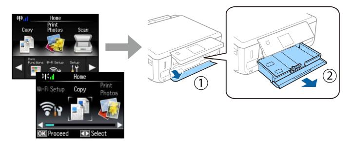
A impressora tem um alimentador inferior e um alimentador superior. Certifique-se de que puxa para fora o alimentador inferior.
