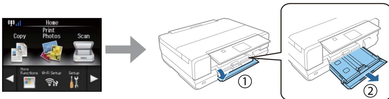
La impresora tiene una bandeja inferior y otra superior. Despliegue la inferior.
