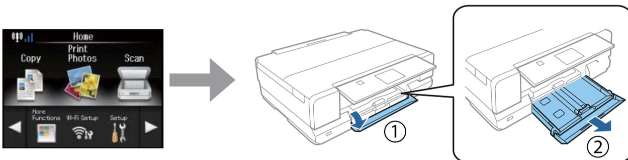
A impressora tem um alimentador inferior e um alimentador superior. Certifique-se de que puxa para fora o alimentador inferior.
