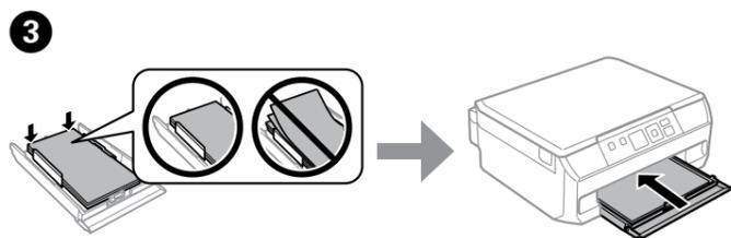
Align the edge guides to the edges of the paper. Keep the cassette flat and insert it back into the product carefully and slowly. Aligned les guides latéraux sur les bords du papier. Maintenez l'unité à plat et réinsérez-la délicatement et doucement dans le produit.
