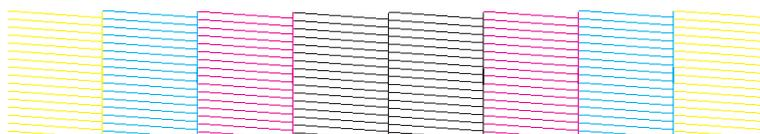
Si falta algún segmento en las líneas impresas, como se muestra a continuación, el cabezal de impresión podría estar obstruido o desalineado.
