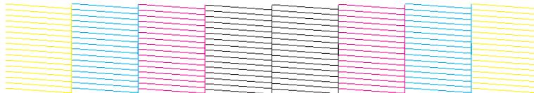
Hvis et segment av de utskrevne linjene mangler, som vist nedenfor, kan det bety at en dyse er tett eller at skrivehode er feiljustert.
