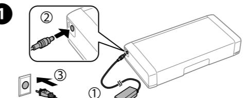
Ligue o cabo de alimentação AC à impressora e à corrente.
