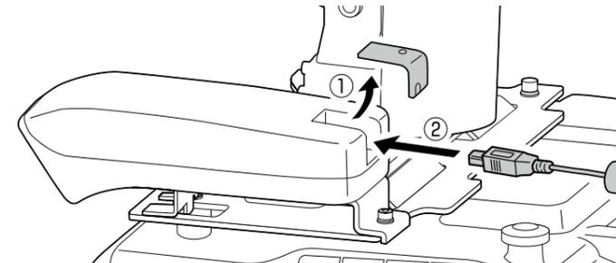
**4** Bringen Sie die USB-Abdeckung wieder an und sichern Sie sie mit der Kreuzschlitzschraube M3 x 8mm.
