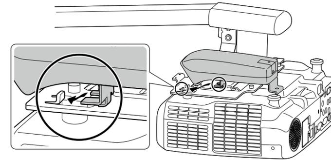
**2** Verwenden Sie die Schraube M4 x 10 mm mit Beileg- und Federscheibe zum Sichern der Interactive Unit.
