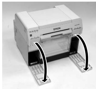
**Otvorte kryty kaziet.****Deschideți capacele cartușelor.****Отворете капаците на касетите.****Atveriet kasetu nodalijuma vākus.****Atidarykite kasečių dangtelius.****Avage kasseti kaaned.**
