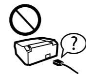
استخدم سلك الطاقة الذي يورد مع الطابعة. سيسبيس استخدام سلك آخر في إحداث حريق أو صدمة كهربائية. لا تستخدم السلك مع أي جهاز آخر.
