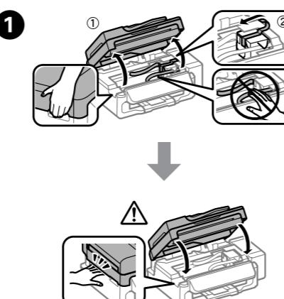
Entfernen Sie das gesamte Schutzmaterial.
