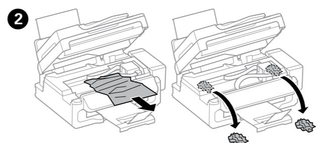
Entfernen Sie das gesamte Papier aus dem Inneren des Druckers einschließlich abgerissener Stücke.
