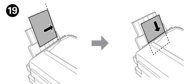
Papier mit der bedruckbaren Seite nach oben einlegen.
