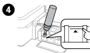
Befolgen Sie zum Einfüllen der Tinte bis zur oberen Markierung die Schritte 4 bis 11 in Abschnitt 3 auf der Vorderseite.
