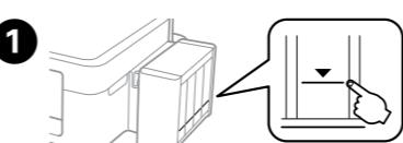
Überprüfen Sie die Tintenfüllstände aller Tintenbehälter per Sichtkontrolle. Unterschreitet der Tintenfüllstand die unteren Markierung auf den Behältern, fahren Sie mit Schritt 2 fort, um die Behälter nachzufüllen.
