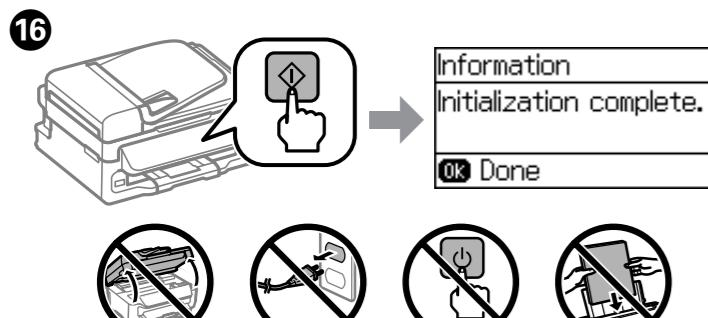
Vergewissern, dass die Behälter mit Tinte gefüllt sind und anschließend **OK** drücken, um die Druckköpfe mit Tinte zu laden. Der Ladevorgang nimmt etwa 20 Minuten in Anspruch.
