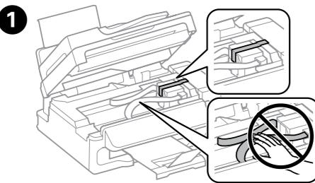
Druckkopf mit Klebeband sichern.
