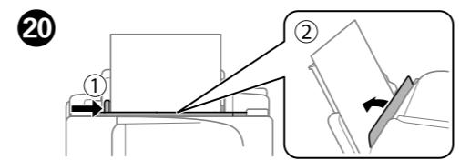
Kantenführung einschieben und Einzugsschutz dann schließen.
