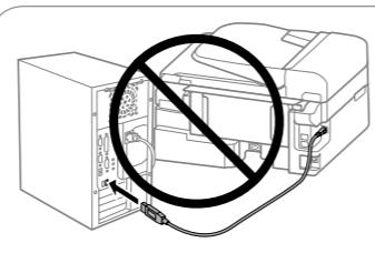
Schließen Sie kein USB-Kabel an, wenn Sie nicht ausdrücklich dazu aufgefordert werden.
