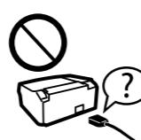
Verwenden Sie nur das im Lieferumfang des Druckers enthaltene Netzkabel. Durch die Verwendung eines anderen Kabels kann ein Brand oder ein Stromschlag ausgelöst werden. Verwenden Sie das Kabel nicht zum Anschließen anderer Geräte.
