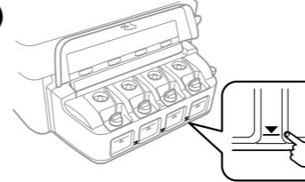
Controllare visivamente i livelli di inchiostro in tutti i serbatoi. Se il livello di inchiostro si trova sotto la linea inferiore, passare al punto ② per riempire i serbatoi.
