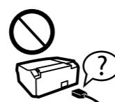
Utilizzare solo il cavo di alimentazione fornito con la stampante. L'utilizzo di un altro cavo potrebbe provocare un incendio o un cortocircuito. Non utilizzare il cavo per nessun'altra apparecchiatura.
