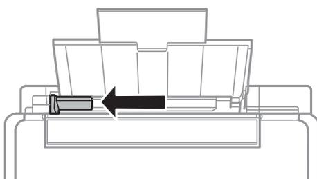
3. Chargez le papier verticalement le long du côté droit de l'alim. papier arrière avec le côté imprimable orienté vers le haut.
