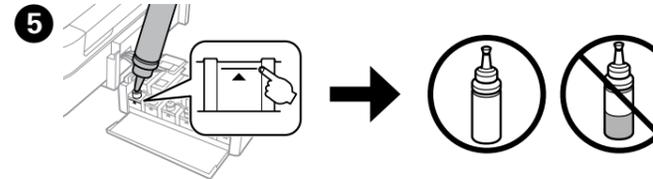
Mürekkep rengini tankla eşleştirin ve sonra tüm mürekkebi doldurun. Ταϊριάξτε το χρώμα του μελανιού με το αντίστοιχο δοχείο και έπειτα γεμίστε το δοχείο με όλο το μελάνι. Potriviti culoarea cernelii cu rezervorul și apoi alimentați cu toată cerneala. Изберете цвета на мастилото според резервоара, после го напълнете с цялото мастило.
