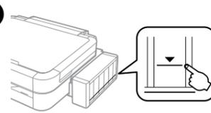
Tüm mürekkep tanklarındaki mürekkep seviyelerini görsel olarak kontrol edin. Mürekkep seviyesi tanklardaki alt çizginin altındaysa tankları doldurmak için adım 2'ye gidin.
