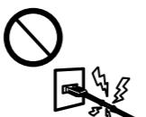
Nie dopuścić do uszkodzenia ani przetarcia przewodu zasilającego. Zabraňte jakémukoli poškozeniu napájecího kabelu. Ügyeljen arra, hogy a tápkábel ne sérüljön meg, és ne rojtoldójon ki. Nedovolte, aby sa napájací kábel poškodil, prípadne rozodral.
