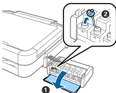
**3** Odlomite vršak kapice, skinite kapicu s bočice za tintu, uklonite zaplovku s bočice, a zatim dobro pritegnite kapicu.
