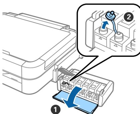
**3** Odlomite vršak kapice, skinite kapicu s bočice za tintu, uklonite zaptivku s bočice, a zatim dobro pritegnite kapicu.
