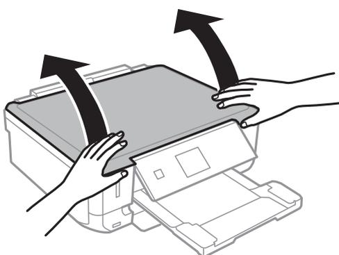
2. Elimine las manchas y el polvo del cristal del escáner.
