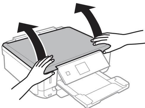
2. Utilice un paño seco, limpio y suave para limpiar la superficie del cristal del escáner.
