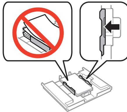
8. Inserte la cassette de papel 1. Coloque la impresora y la bandeja de forma que las marcas de alineación queden paralelas.
