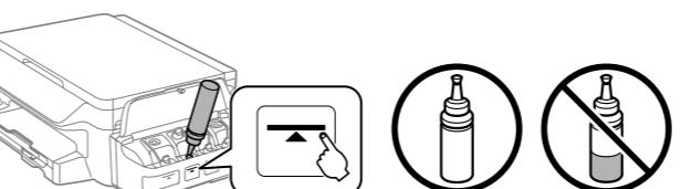
Füllen Sie jeden Tank mit Tinte der richtigen Farbe. Verwenden Sie die gesamte Tinte in der Flasche.
