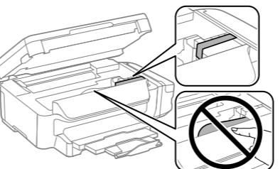
Sichern Sie den Druckkopf mit Klebeband.
