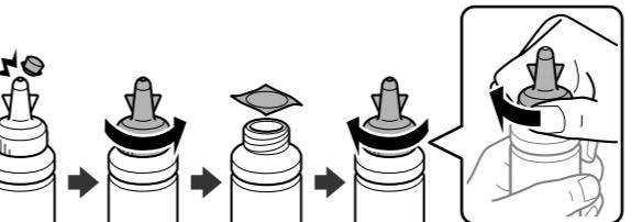
Abknicken, entfernen und anschließend fest verschließen.
