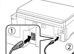
Schließen Sie das Netzkabel an Gerät und Stromversorgung an.
