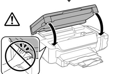
Entfernen Sie das gesamte Schutzmaterial.
