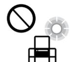
Μην τοποθετείτε και μην αποθηκεύετε τη συσκευή σε εξωτερικούς χώρους, κοντά σε σημεία με πολλές ακαθαρσίες ή υπερβολική σκόνη, κοντά σε νερό, πηγές θερμότητας ή σε σημεία που υπόκεινται σε κραδασμούς, δονήσεις, υψηλές θερμοκρασίες ή υγρασία.
