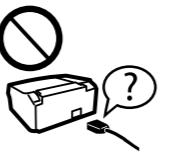
Utilisez uniquement le cordon d'alimentation fourni avec l'imprimante. L'utilisation d'un autre cordon peut entraîner un incendie ou une décharge. N'utilisez pas le cordon avec autre équipement.
