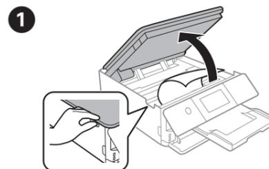
1 Abra a unidade do scanner e retire todo o papel que se encontrar no interior, incluindo pedaços rasgados. Åbn scannerenheten, og fjern alt papir indeni, inklusive iturevne stykker.
