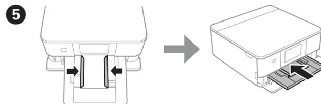
Deslize os guias de margem para as extremidades dos originais. Mantenha o alimentador plano e insira-o novamente na impressora cuidadosamente e lentamente.
