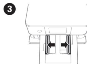
Deslize os guias de margem até à posição máxima. Skub kantstyrene ud til deres maksimale position. Liu´uta reunan ohjaimet maksimiasentoon. Skyv kantskinnene ut til maksimal posisjon. Skjut ut kantstöden till deras maximala läge.
