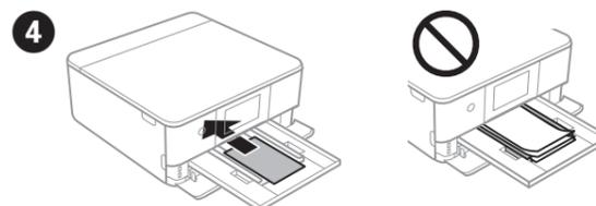
Coloque o papel no alimentador de papel com o lado a imprimir voltado para baixo, até o papel tocar na extremidade.
