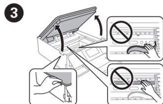
3 Abra a unidade do scanner. Åben scannerenheden. Avaa skanneriyksikkö. Åpne skannerenheten. Öppna skannerenheten.
