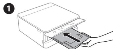
Quando o recetor for ejetado, certifique-se de que não há papel no mesmo e, em seguida, feche-o empurrando o recetor com a mão. O recetor fecha automaticamente quando a impressora estiver a ligar. Empurre o recetor até ao final quando a impressora estiver a desligar. Caso contrário, não é possível fechar o painel de controlo.
