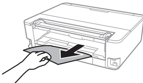
3. Entfernen von gestautem Papier über die hintere Abdeckung
