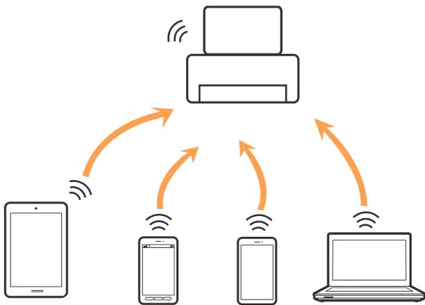
Der Drucker kann gleichzeitig über Wi-Fi oder Ethernet und Wi-Fi Direct (Simple AP) verbunden werden. Wenn Sie jedoch in Wi-Fi Direct (Simple AP) eine Netzwerkverbindung starten, wenn der Drucker über Wi-Fi verbunden ist, wird die Wi-Fi-Verbindung vorübergehend getrennt.
