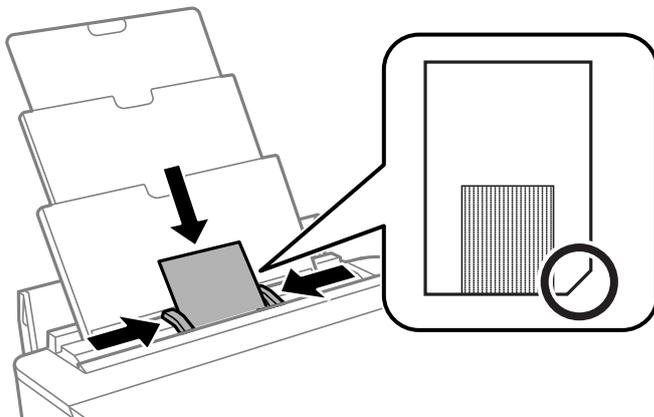
6. Befolgen Sie zum Reinigen der Papierzuführung die Anweisungen am Bildschirm. Wiederholen Sie diesen Vorgang zwei- oder dreimal.
