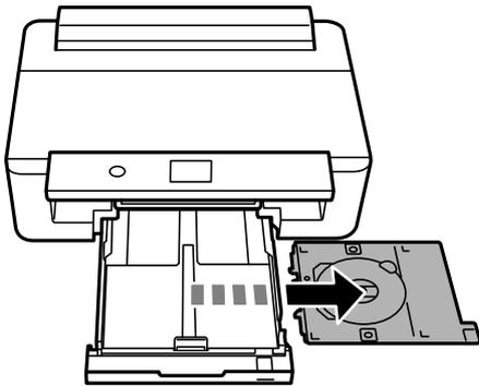
7. Legen Sie eine CD/DVD mit der Druckseite nach oben auf den CD/DVD-Träger. Drücken Sie auf die Mitte der CD/DVD, um sie sicher in den Träger einzusetzen.
