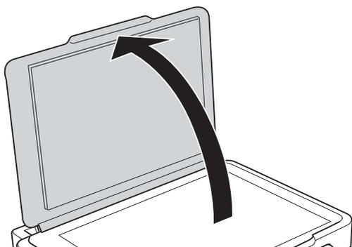
2. Utilice un paño seco, suave y limpio para limpiar la superficie del cristal del escáner.
