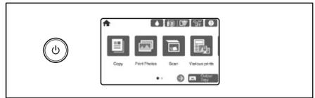
Liga ou desliga a impressora. Tænder eller slukker for printeren. Kytkee tulostimen päälle tai pois päältä. Slår skrivaren på eller av. Startar och stänger av skrivaren.
