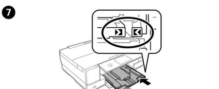
Mantenha o alimentador plano e insira-o novamente na impressora cuidadosamente e lentamente. Hold kassetten fladt og sæt den forsigtigt og langsomt tilbage i printeren. Pida kasetti tasaisena ja aseta se hitaasti takaisin tulostimeen.
