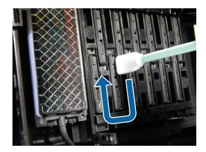
(2) Sujete el bastoncillo de limpieza en vertical y limpie las partes externas de todas las tapas de secado.
