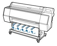
Baje los brazos izquierdo y derecho del cesto de papel hacia usted hasta que toquen la sección del rollo.
