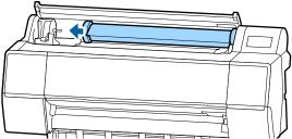
Girare il rotolo di carta sul lato anteriore per posizionarlo sulla parte superiore della stampante.
