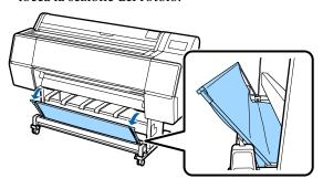
Abbassare i supporti di uscita fino a quando non sono verticali, come mostrato nell'illustrazione.
