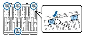
(5) In caso di lanugine o polvere nei cappucci, rimuovere con la punta del bastoncino di pulizia o con una pinzetta.
