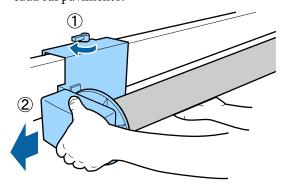
Rimuovere l'anima del rotolo dall'unità a bobina per il prelievo automatico.
