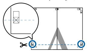
Sovrapporre il foglio superiore sul foglio inferiore. Allineare i crocini X come mostrato nella figura sotto e fissarli temporaneamente applicando del nastro adesivo sul retro.
