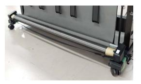
Rimuovere l'unità a bobina opzionale per il prelievo automatico o il dispositivo di montaggio SpectroProofer se sono installati.
