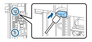
(4) In caso di lanugine o polvere nei cappucci, rimuovere con la punta del bastoncino di pulizia o con una pinzetta.
