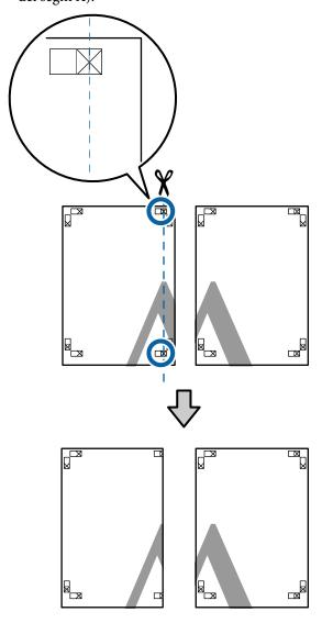
Sovrapporre il foglio superiore di sinistra sul foglio superiore di destra. Allineare i crocini X come mostrato nella figura sotto e fissarli temporaneamente applicando del nastro adesivo sul retro.
