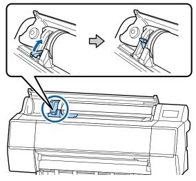
Inserire il bordo iniziale della carta in rotolo dritto all'interno dell'alloggiamento di alimentazione della carta e continuare l'inserimento fino a quando non si sente un segnale acustico.
