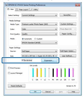
Selezionare Auto Expand (Autoespansione) o Retain Size (Conserva formato) per Method of Enlargement (Metodo di ingrandimento).
