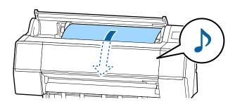
Quando l'alimentazione automatica della carta è impostata su Spento, inserire il bordo iniziale della carta in rotolo nell'alloggiamento di alimentazione della carta e inserire fino a quando il bordo iniziale non esce dalla stampante.
