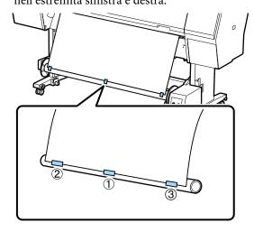
Tenere l'interruttore Manual sull'unità a bobina per il prelievo automatico su Forward per avvolgere la carta tre volte attorno all'anima.
