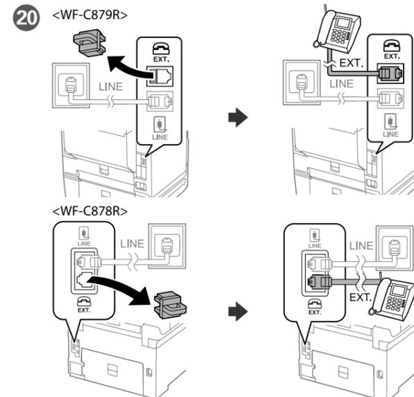
Ako želite da delite istu telefonsku liniju kao vaš telefon, uklonite poklopac, a zatim priključite telefon u ulaz EXT. Aby korzystać z tej samej linii co telefon, wyjmij zaślepkę i podłącz telefon do gniazda EXT.
