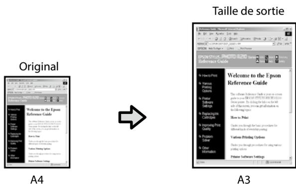
Sélectionnez **Output Size (Taille de sortie) - Fit to Output Size (Ajuster à taille sortie)**, puis sélectionnez la taille de sortie.
