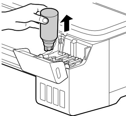
Nenechávajte atramentovú fľašu vloženú; v opačnom prípade môže dôjsť k poškodeniu fľaše alebo k úniku atramentu.
