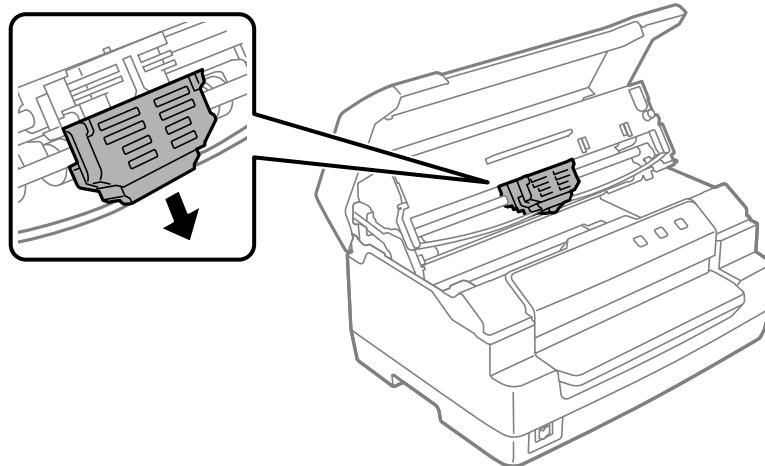
7. Držite obe strane trake za štampač obema rukama i rotirajte je na plastičnim kukama. Zatim je vucite nagore dok ne izađe iz štampača.
