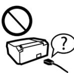
Να χρησιμοποιείτε αποκλειστικά το καλώδιο τροφοδοσίας που παρέχεται με αυτό το προϊόν. Η χρήση διαφορετικού καλωδίου μπορεί να οδηγήσει σε πυρκαγιά ή ηλεκτροπληξία. Μην χρησιμοποιείτε το καλώδιο τροφοδοσίας σε συνδυασμό με άλλον εξοπλισμό.
